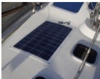
Et af Troldands tre sol-cellepaneler på hvert 55 watt (Sun Ware)
