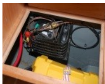
I en separat gruppe 2x 60 Ah/12 volt Optima spiralcellebatterier, der endvidere forsyner ankerspil & bovpropel
