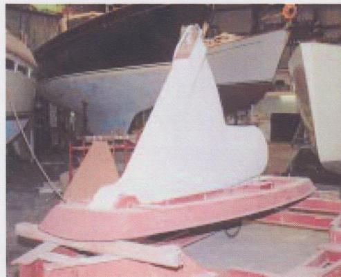
**Der Schwenkkiel und seine solide gusseiserne Grundplatte geben dem Schiff mehr als drei Tonnen Ballast.**
