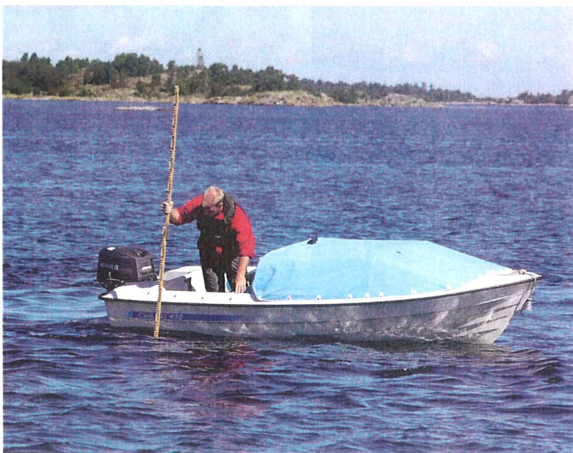
Til feltopmålingerne anvender Hydrographicas medarbejdere en grundtgående båd, og lodskuddene måles manuelt.
