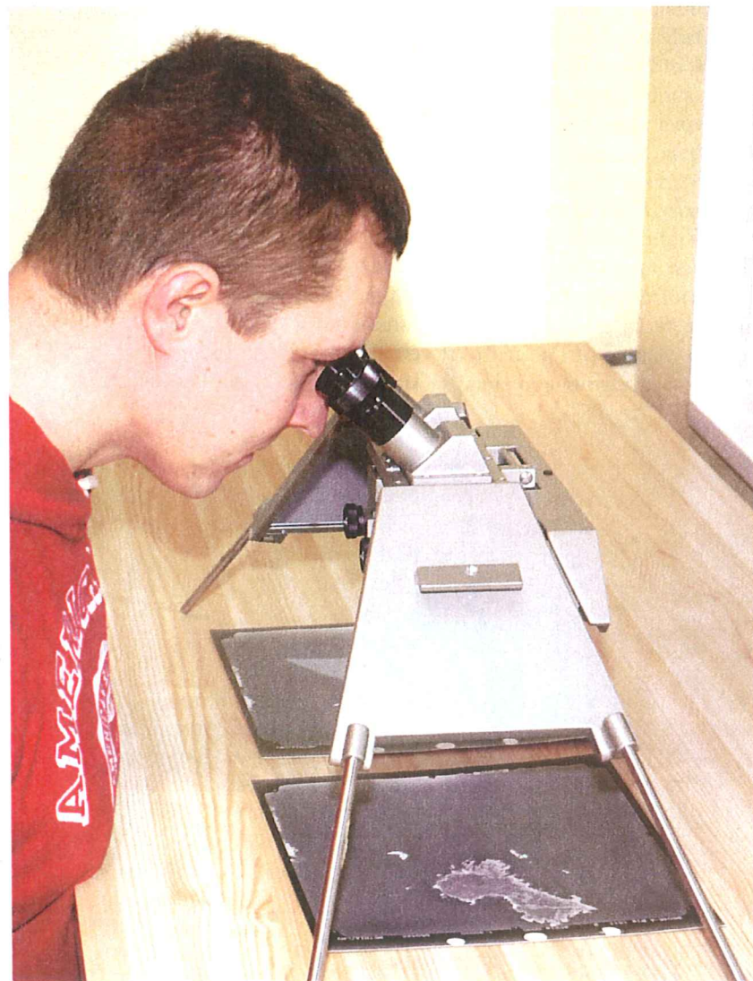
Jesper Sannel er her i fuld gang med at planlægge opmålingen på Hallands Väderö. Instrumentet, han anvender, er et såkaldt stereoskop, hvor samtidig brug af to overlappende luftfotografier giver et tredimensionalt billede.
